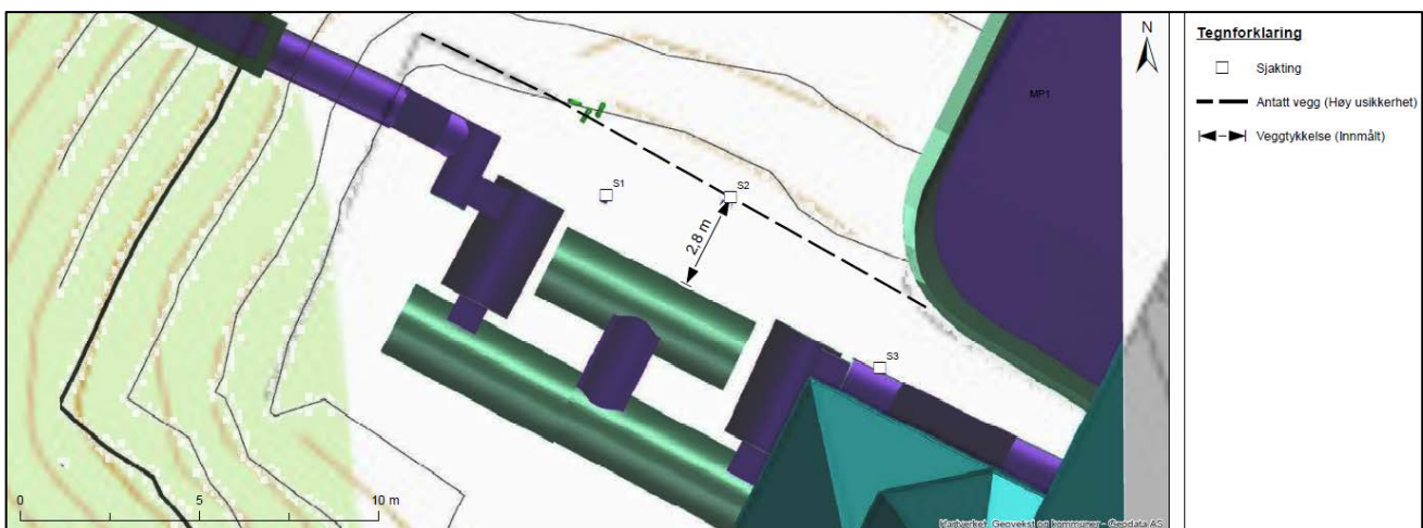
Figur 6: Resultatene fra 3D laserskanning av bunkeren
