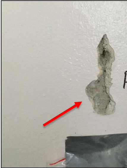
Figur 38: Prøve 3 av maling på betongvegg i et laboratoriet i 3. etasje.
