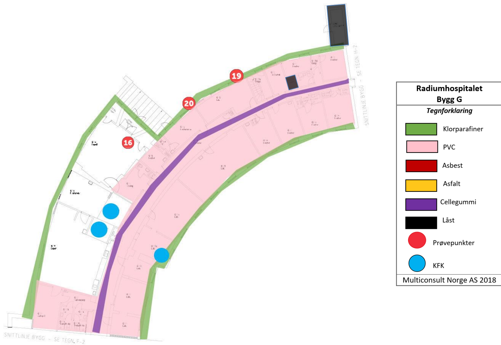
Figur 5: Plantegning 2. etasje Bygg G med prøvetakingspunkt og funn av farlig avfall.
