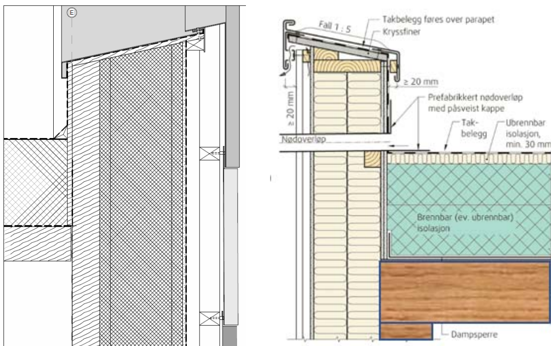
5-1 Detaljtegningen til arkitekt til venstre viser arkitektonisk uttrykk. Prinsippdetalj fra byggforsk viser tradisjonell gesimsløsning for fasade med platekledning. Det skal benyttes massivtre elementer som bærende tak
