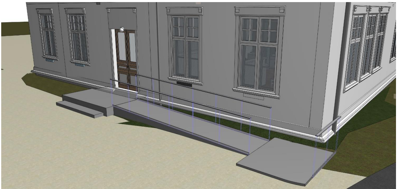
3D-skisse av trapp, rampe og rekkverk.
