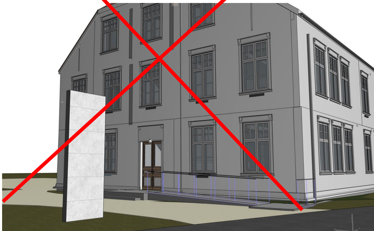
Skiltskisse. Metallkassetter på ramme. 1,2x4 m.
