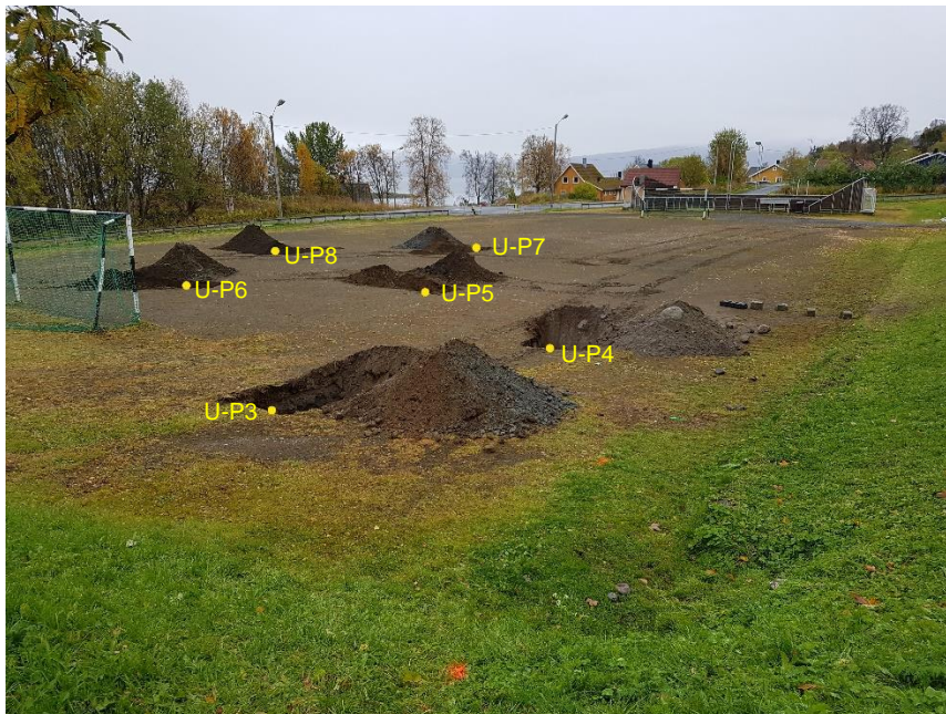
Figur 2-2 Oversikt over deler av området der nybygget skal lokaliseres. Prøvepunktene U-P3, U-P4, U-P5, U-P6, U-P7, U-P8 er markert inn. Området består i hovedsak av fyllmasser i form av små stein og sand.
