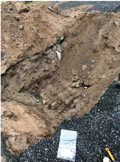
Figur 2-5 Bildet viser prøvesjakt 11 (B-P3), og er 1 m dypt. Massene i sjakten er typisk for området for branntomta og består sand, stein og betongrister. Et svart lag med svart grus ble observert på 0-0,1 m dyp.
