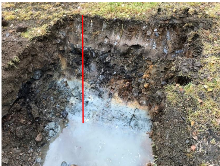
Figur 2-3 Bildet viser prøvesjakt 4 (U-P4). Sjakten er 1 m dyp. Svart lag ble observert på 0,2-0,4 m dyp. På 1 m dyp ble det observert grå leire. Det var vanninntrengning i sjakten.
