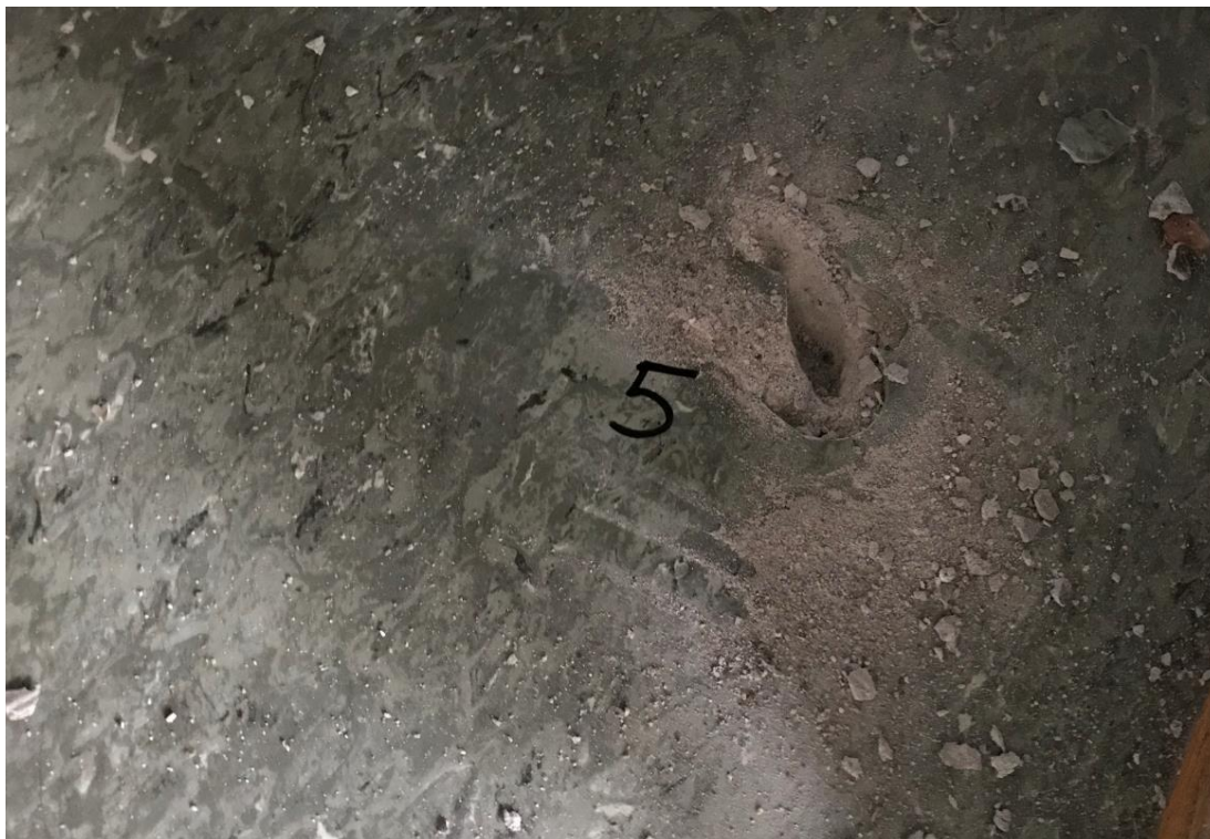
Bilde 3 – Bilde fra prøve 5. Grønt gulvbelegg i gangareal ble analysert for ftalater. Prøven viser en forekomst av ftalater over grensen for farlig avfall. Gulvbelegget må leveres som farlig avfall til godkjent mottak. Mengder i tabell, punkt 4.4.
