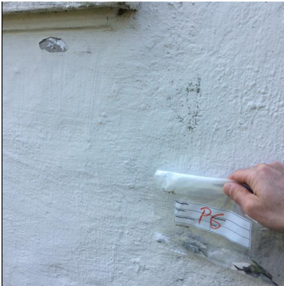
Figur 17: Utvendig, lys maling på murvegg (P6) på nordøstre fasade i Lotheveien 14. Det ble ikke påvist konsentrasjoner av tungmetaller eller PCB over normverdi i malingen.
