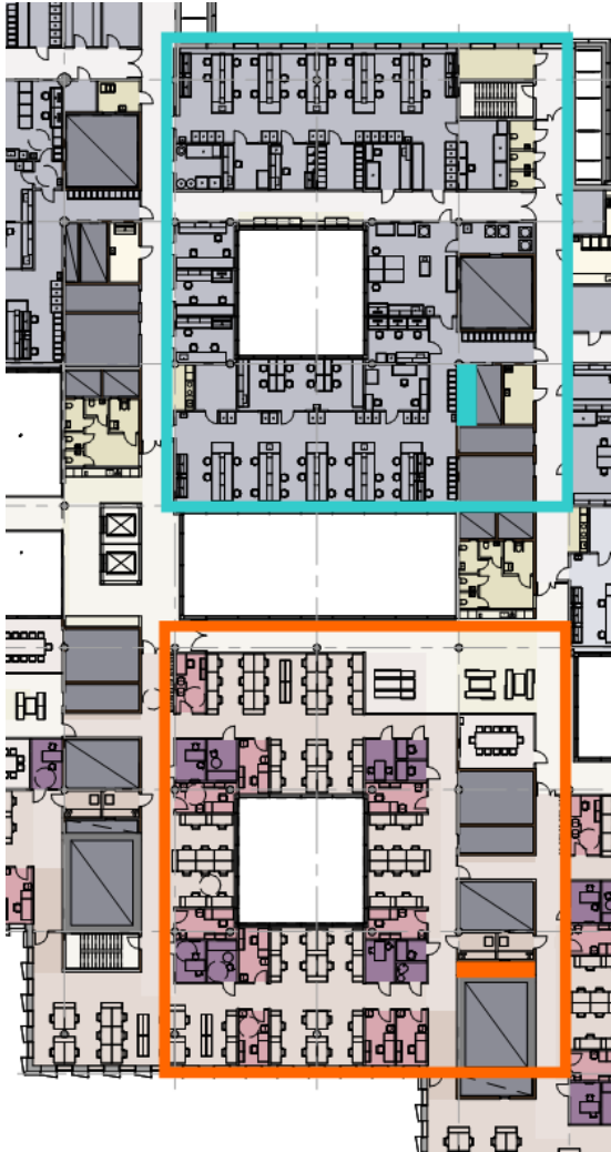
Figur: Rørsjakt per hvert halve felt
