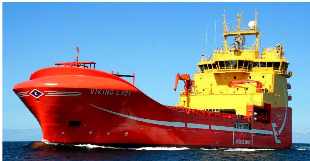
Figur 6 – Eidesvik Viking Lady. Supplybåt drevet av batteri, hydrogen og dual-fuel forbrenningsmotor (LNG eller diesel). (Foto: Eidesvik.no)
