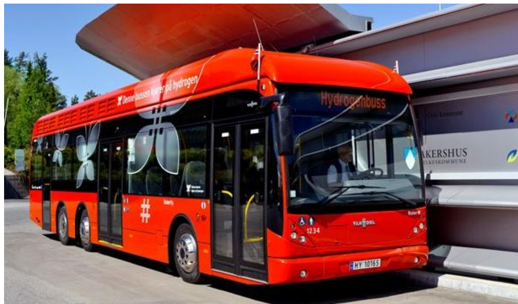
Figur 5 – Ruter-hydrogenbuss ved fyllestasjonen på Rosenholm. Bussene er levert av belgiske Van Hool med 13 meter lengde, tre aksler og 37 sitteplasser. Hydrogen-lagringstankene er plassert under taket. (Foto: Van Hool)
