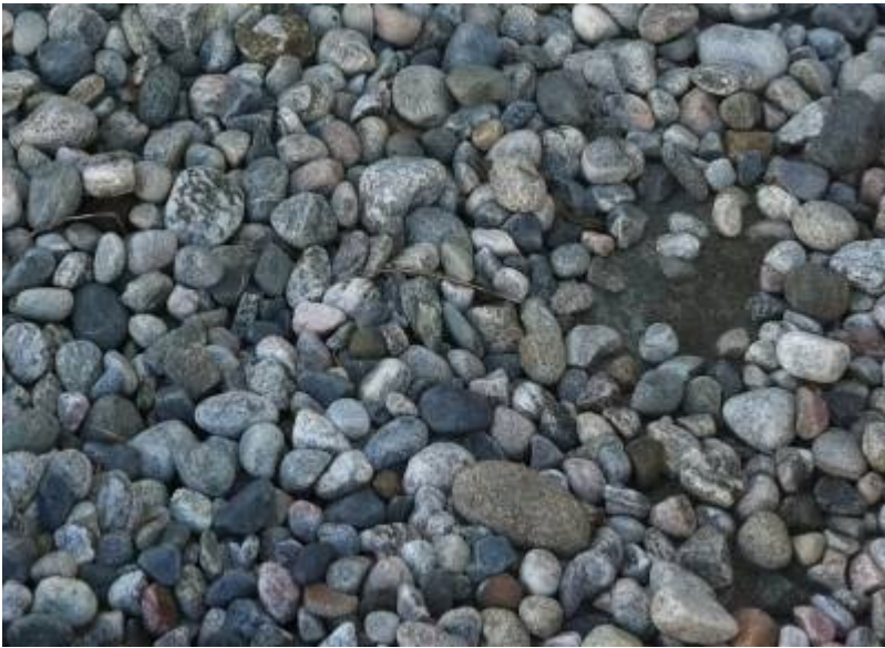
Felt med elvestein (24-60+ mm) i henhold til landskapsplan. Avgrenses med aluminiumskant (3mm tykkelse festet med jordspyd.
