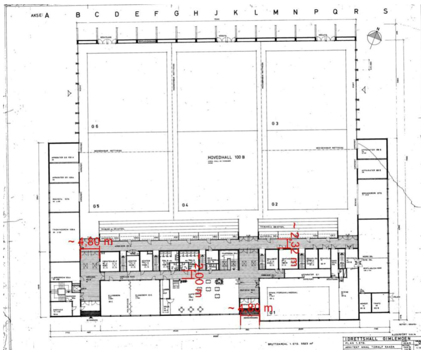
Figur .3 Viser bredde på korridor i 1.etg.
