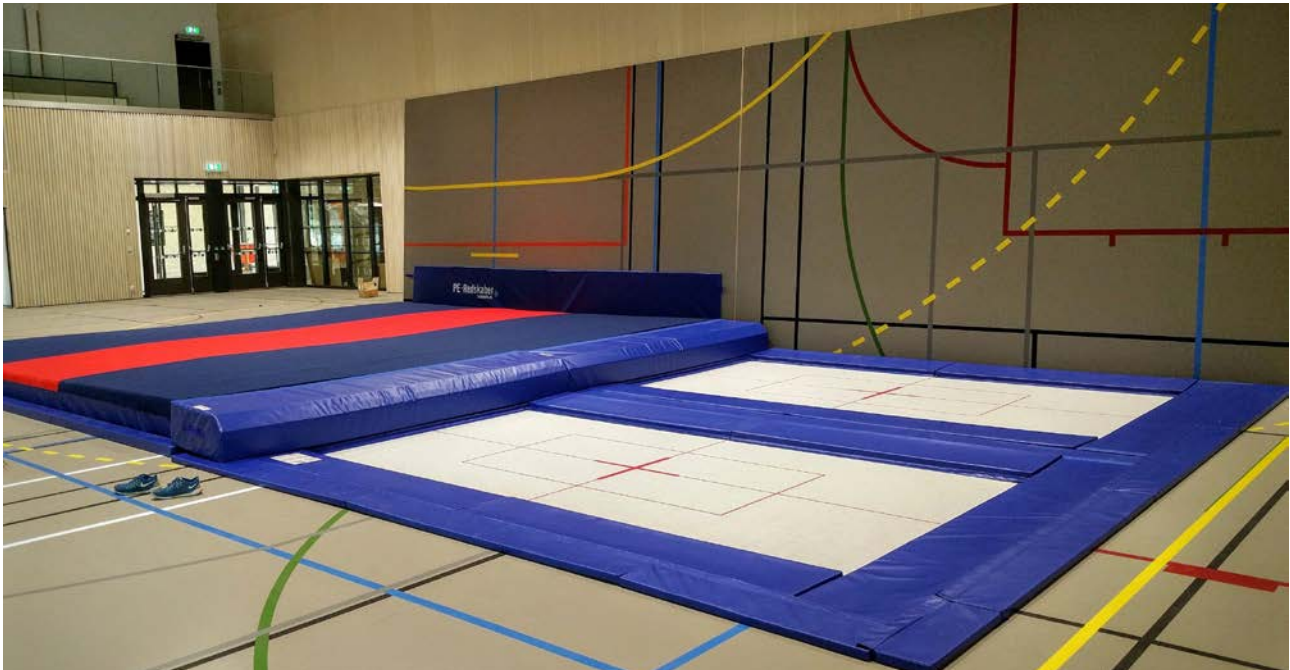
Eksempel på trampoline med hydrauliske lemmer som kan kjøres opp og ned. Foto: Tron Lunde
