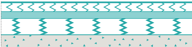
Prinsipiell oppbygging av kombielastisk gulv
