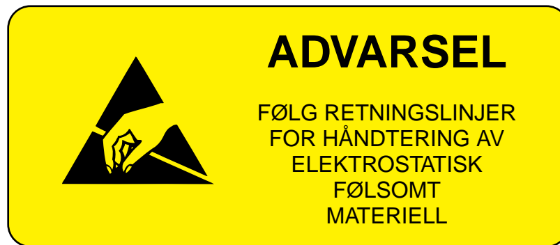
Figur 4-3 Varselmerke for ESD-følsomt materiell
