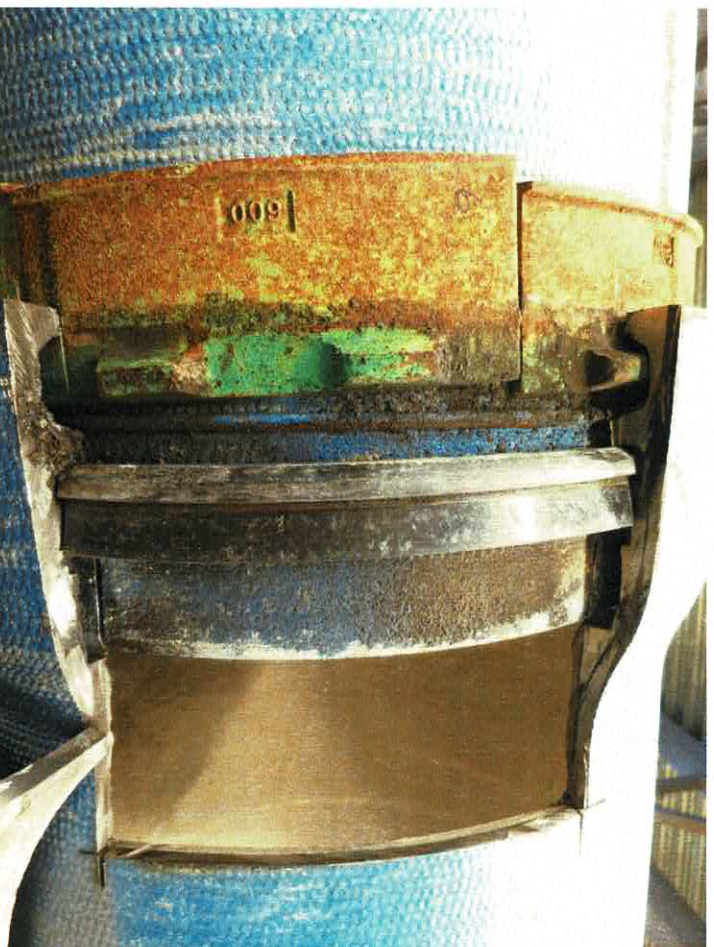
Bilde 2 Åpnet muffekobling, muffekobling 1 (Innersving). Sot på spissendens vannside er fra kappingen
