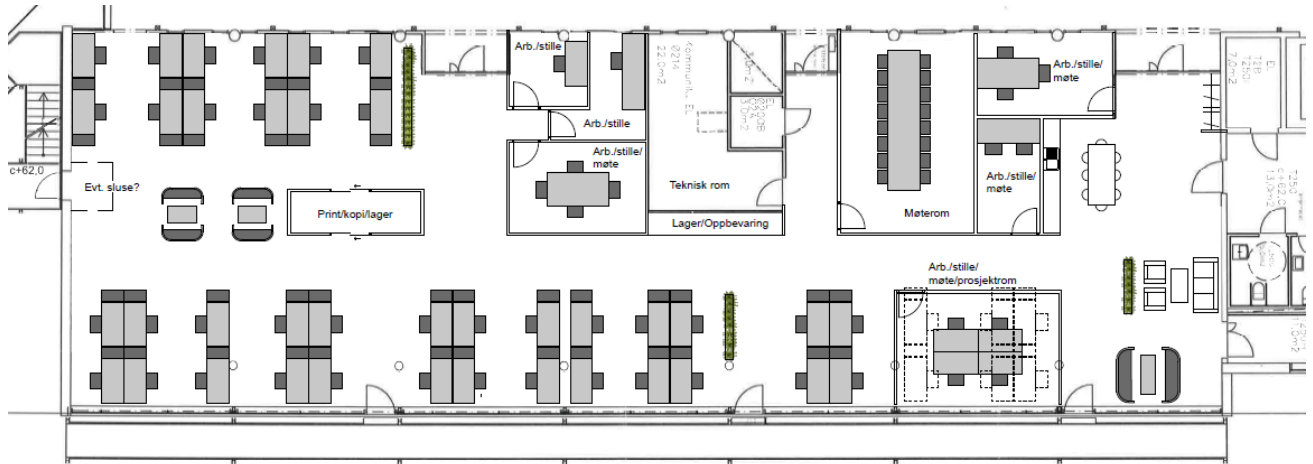
1141601 ARH, opsjon ombygging av 2. etasje øst Eksempel på planløsning med sentralt trafikkareal Eksempel viser 39 (mulig 43) kontorarbeidsplasser og en del rom med fleksible bruksmuligheter (teamkontor, stillerom, møterom e.a.)
