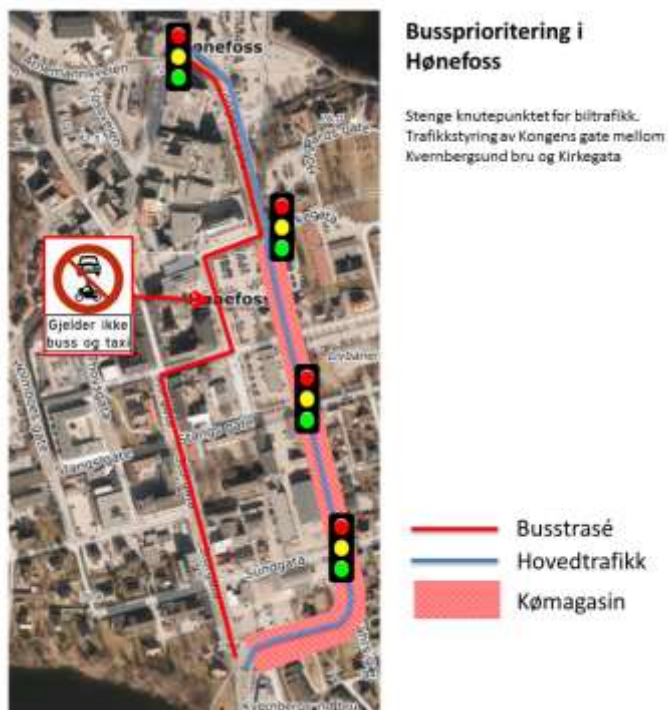
Figur 22 – Prinsipp for kollektivprioritering gjennom Hønefoss sentrum (kart: finn.no)
