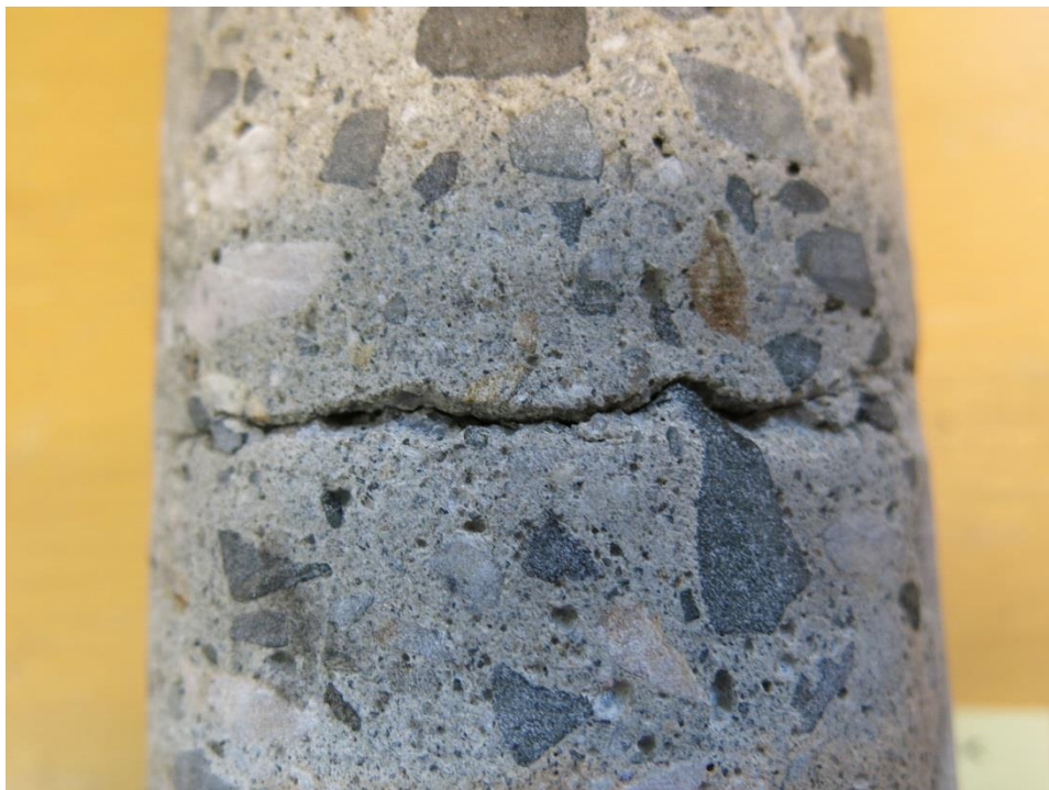
Bilde nr. 7 Begynnende delaminering på prøve nr. 2.
