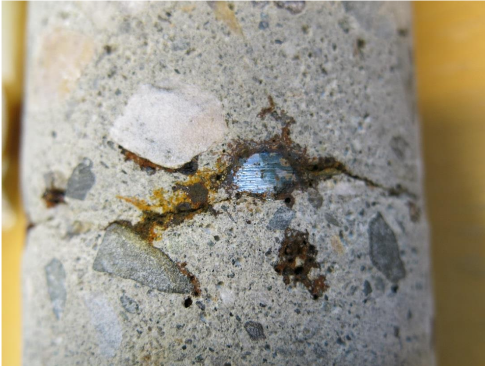
Bilde nr. 8 Begynnende delaminering på prøve nr. 2.
