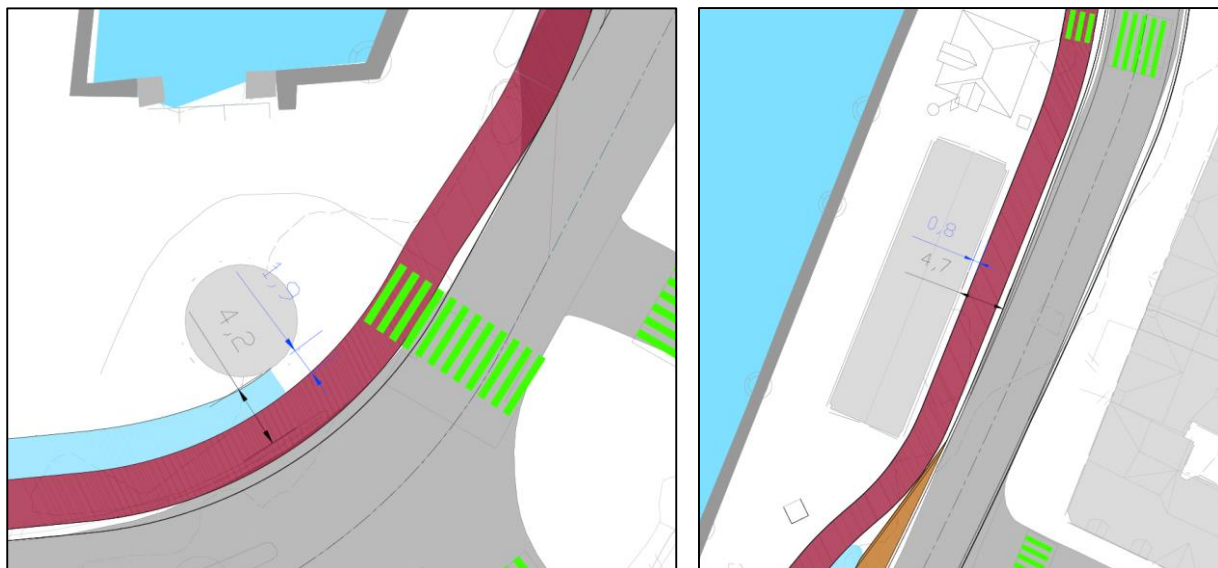
Figur 51; Sykkelvegen passerer Rundetårn og Skur 11 med en avstand på henholdsvis ca. 1,9 og 0,8 meter. Mål i svart viser dagens avstand til kjørebanelen.
