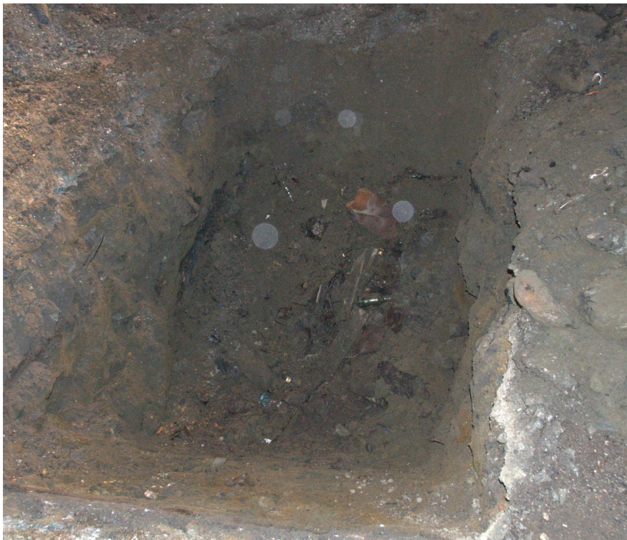
Prøvehull 4. Ca 2 meter dyp. Avfall fra ca 1 meters dyp. Lite omdannet.
