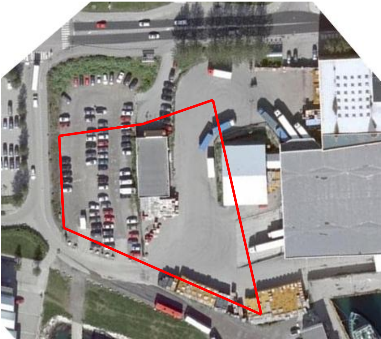
Bilde 5. Viser antatt avgrensning av deponi området på ortofoto. I området i nedre venstre hjørne av bildet ligger avfallet dypest. De er her den opprinnelige sjøbunnen er dypest (se bilde 4).
