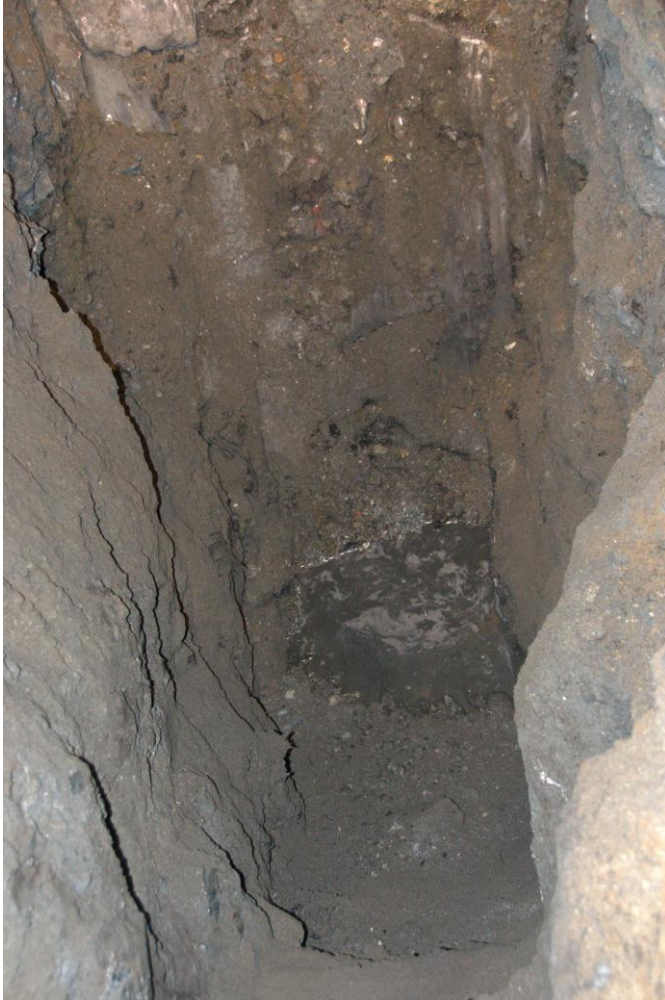
Prøvegrop 1. Dyp ca 2,3 m. Prøve tatt fra de nederste massene som inneholdt sterkt omdannet organisk materiale. Øverste 2 meterne bar mer preg av normale fyllmasser.
