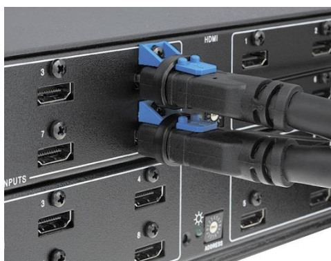
Figur 20. Eksempel på låsemekanisme for HDMI-plugger.
