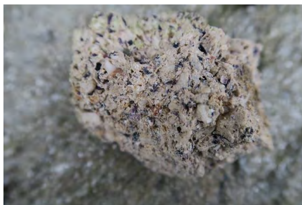
Mørtelbit fra inne i muren, kalkmørtel med høyt innslag av skjellsand.
