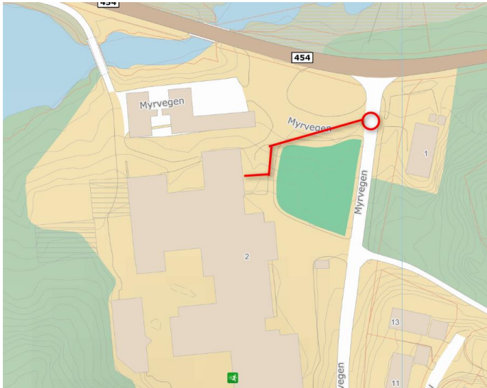
Figur 6: Trasé nytt sprinklerinnlegg, alternativ 1
