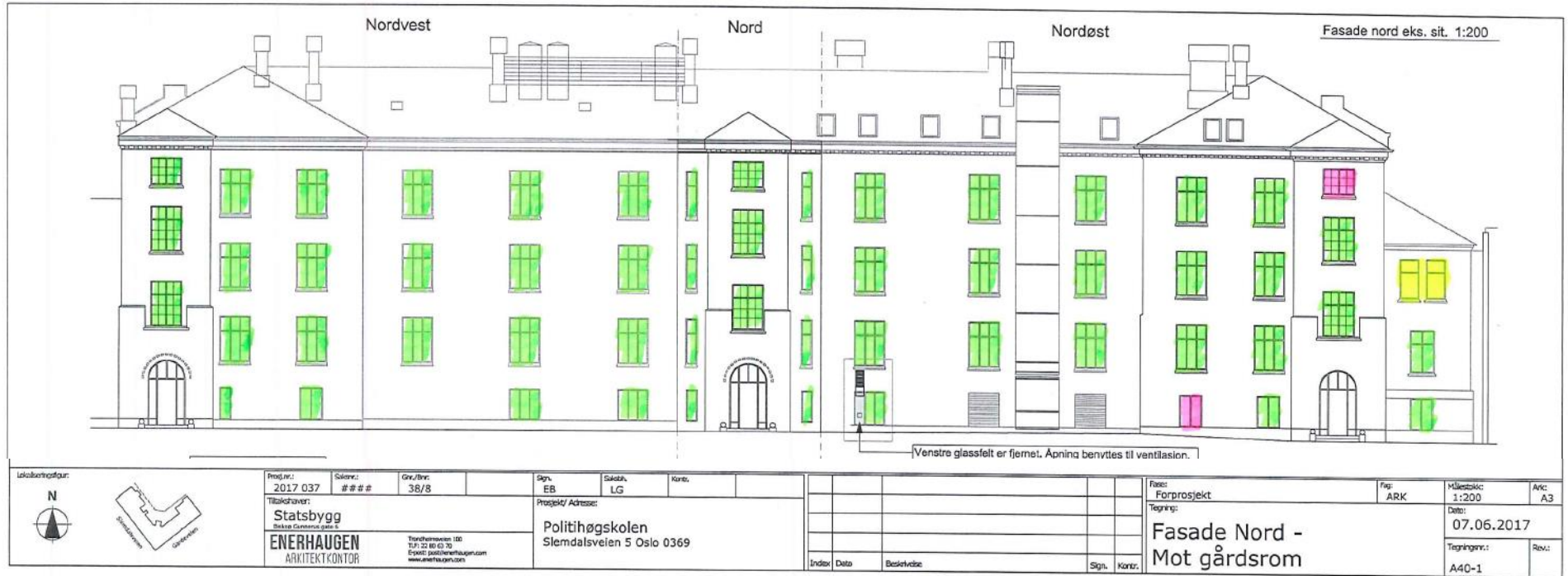
Fasadetegning mot gårdsrom, hvor prøvetaking og funn av farlig avfall er markert.
