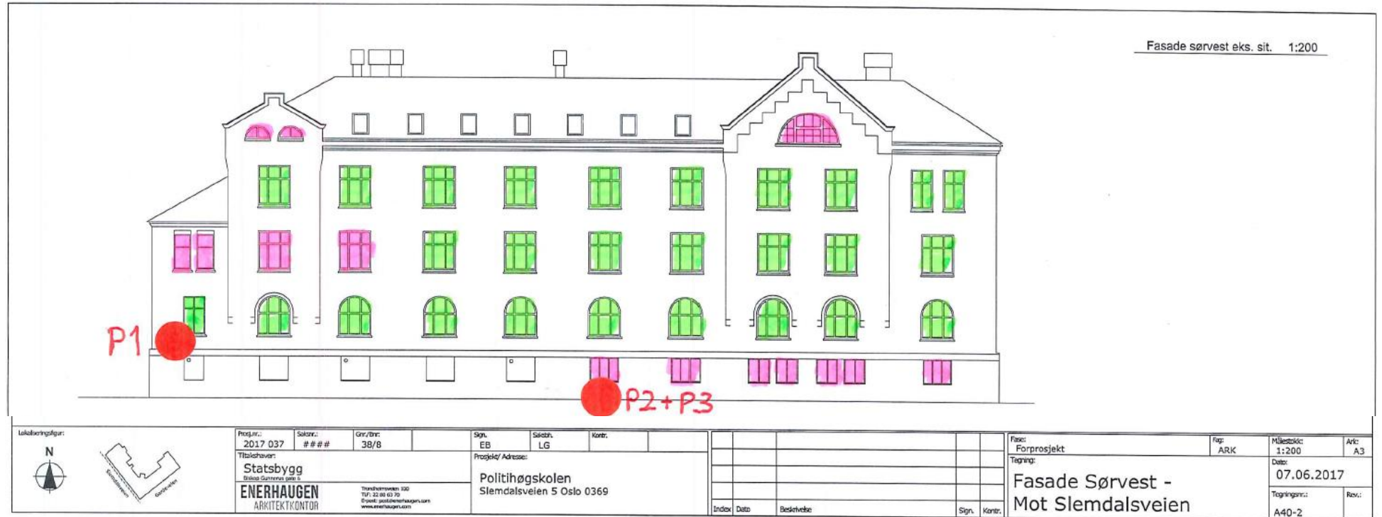
Fasadetegning mot Slemdalsveien, hvor prøvetaking og funn av farlig avfall er markert.
