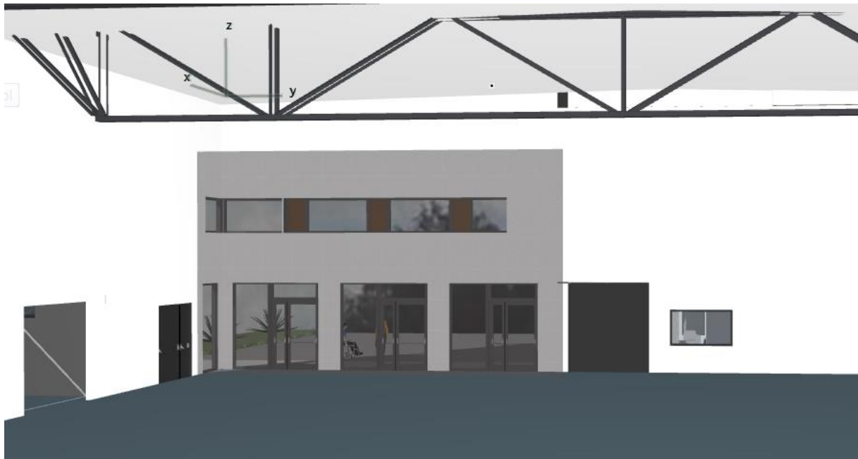
Illustrasjon som viser vinduer som skal dekkes av blendingsduk. Duken skal være helt lystett for absolutt blending.
