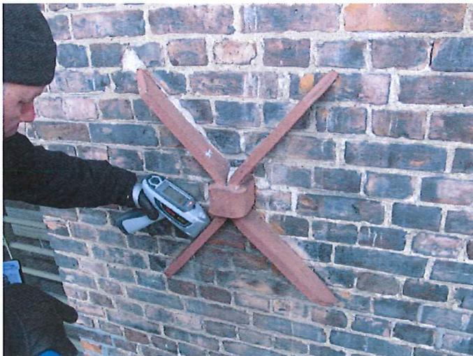
Niton miljøpistol i bruk for kontroll av tungmetaller i maling og rustbeskyttelse.
