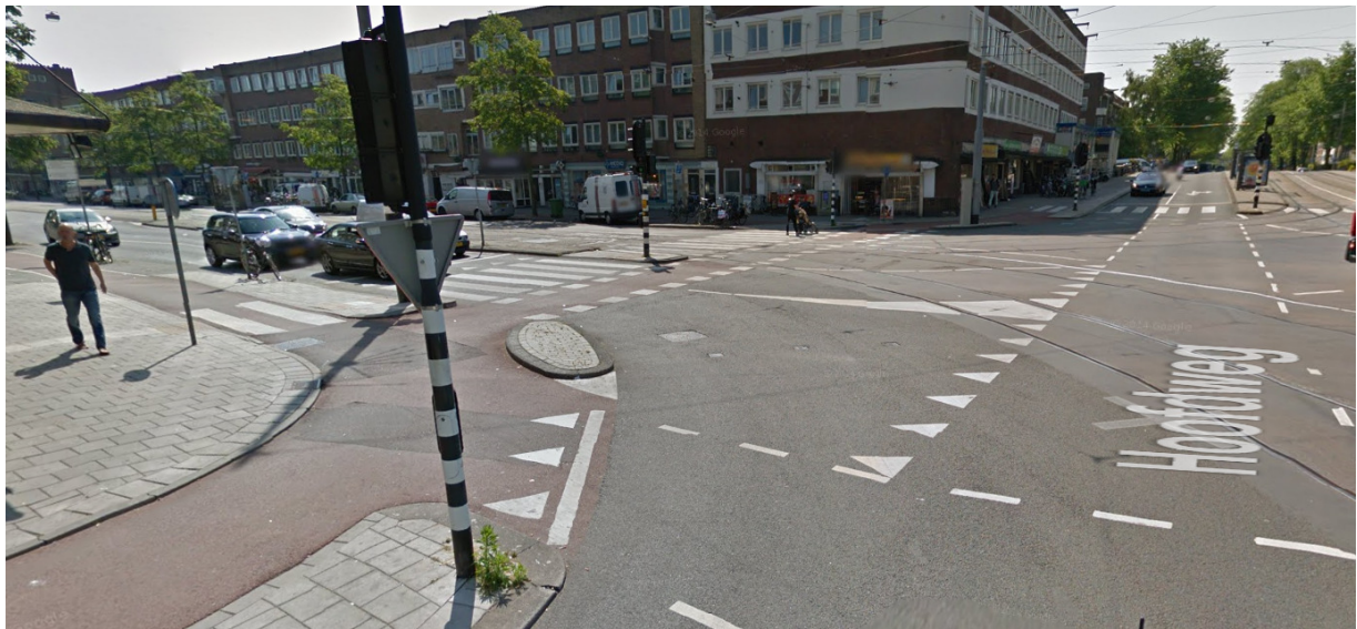
Figur 7: Kryssing basert på stor venstresving og enveis sykkelvei. Hoofvweg, Amsterdam Googles gatebilder
