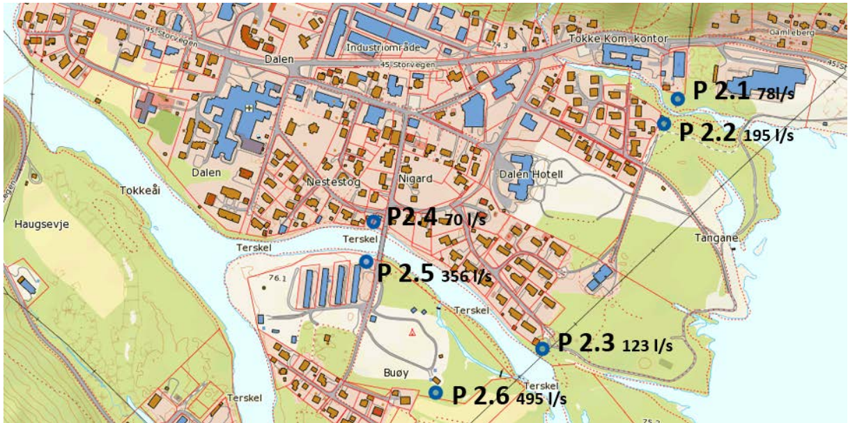
Fig 3.4.4.1 - Oversikt pumpeanlegg (Førebels pumpekapasitet)
