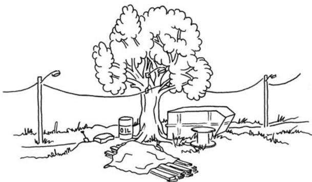
Fig. 41 Trær virker som en magnet for plassering av materialer og utstyr.
