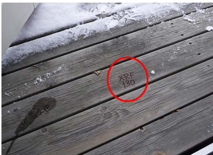
Figur 2: XRF-målepunkt på terrassebord
