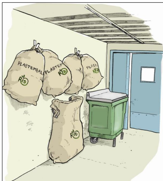
Sekk i veggmontert stativ i avfallsrom. Lagring av fulle sekker på kroker.
