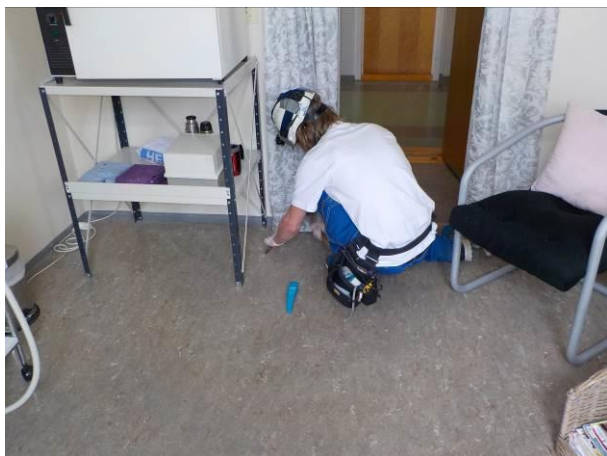
Bilde 9 viser prøvetaking av sort lim under linoleumsbelegg i underetasje i østfløy. Det ble ikke påvist asbest i sort lim.
