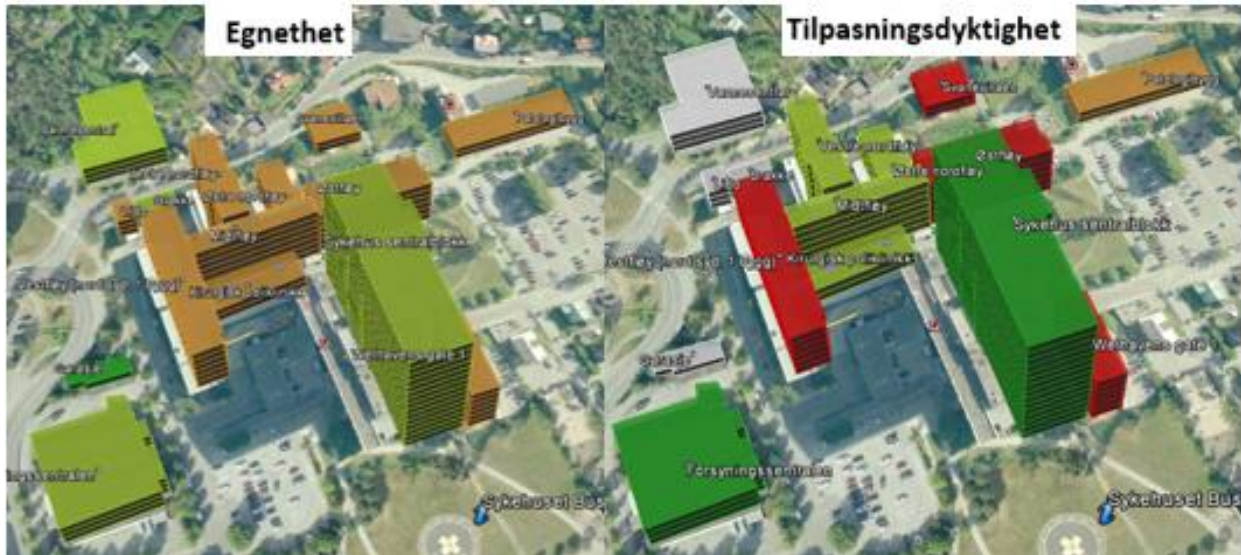
Figur 12 – Oversiktsbilde over egnethet og tilpasningsdyktighet på Drammen sykehus vurdert i 2010 (MultiMap, 2015)
