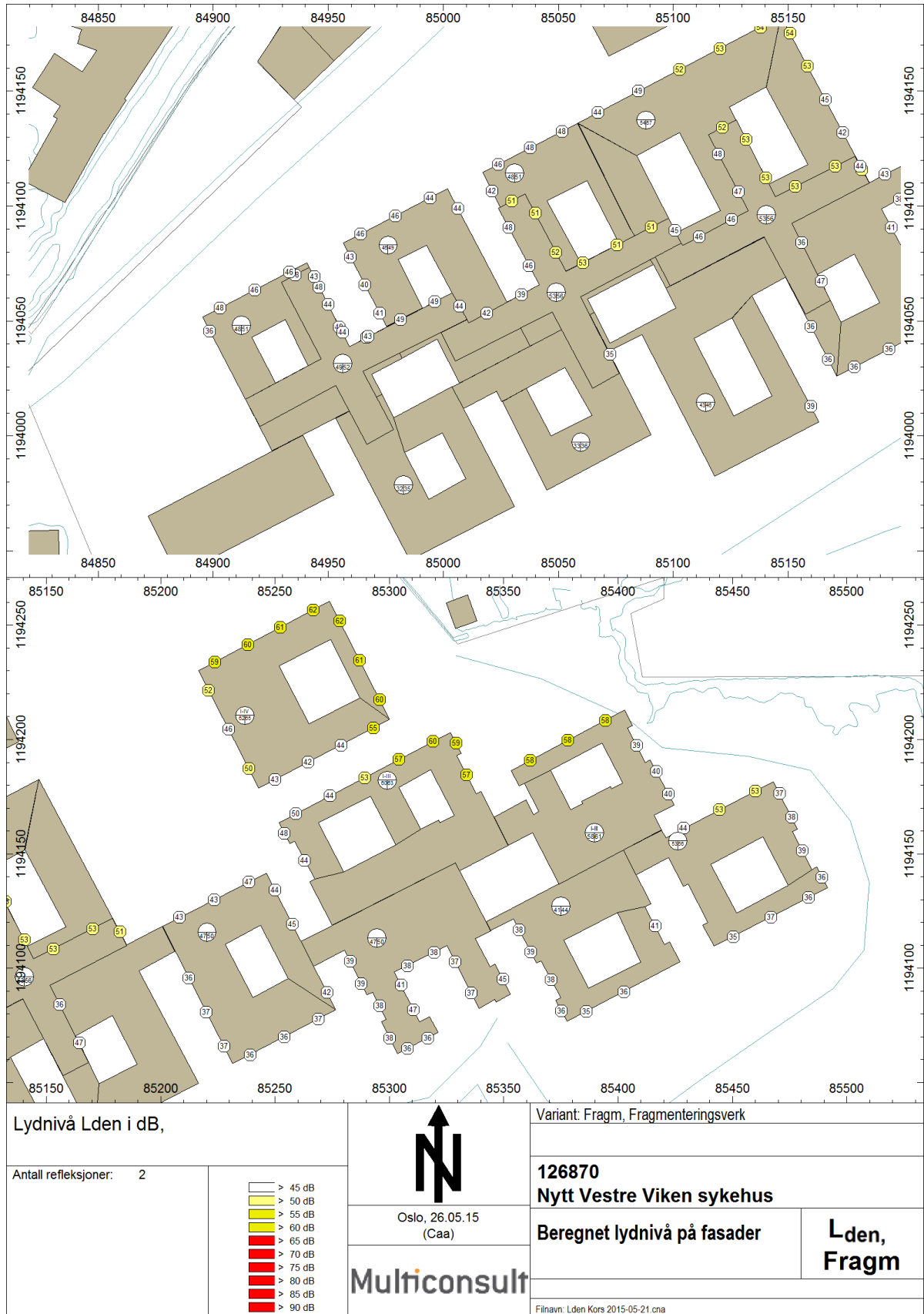
Figur 8: Lydni \ddot{v} å fra fragmenteringsverk. Lydni \ddot{v} å L _{den} [dB]. Figuren viser høyeste beregnede lydni \ddot{v} å uavhengig av etasje.
