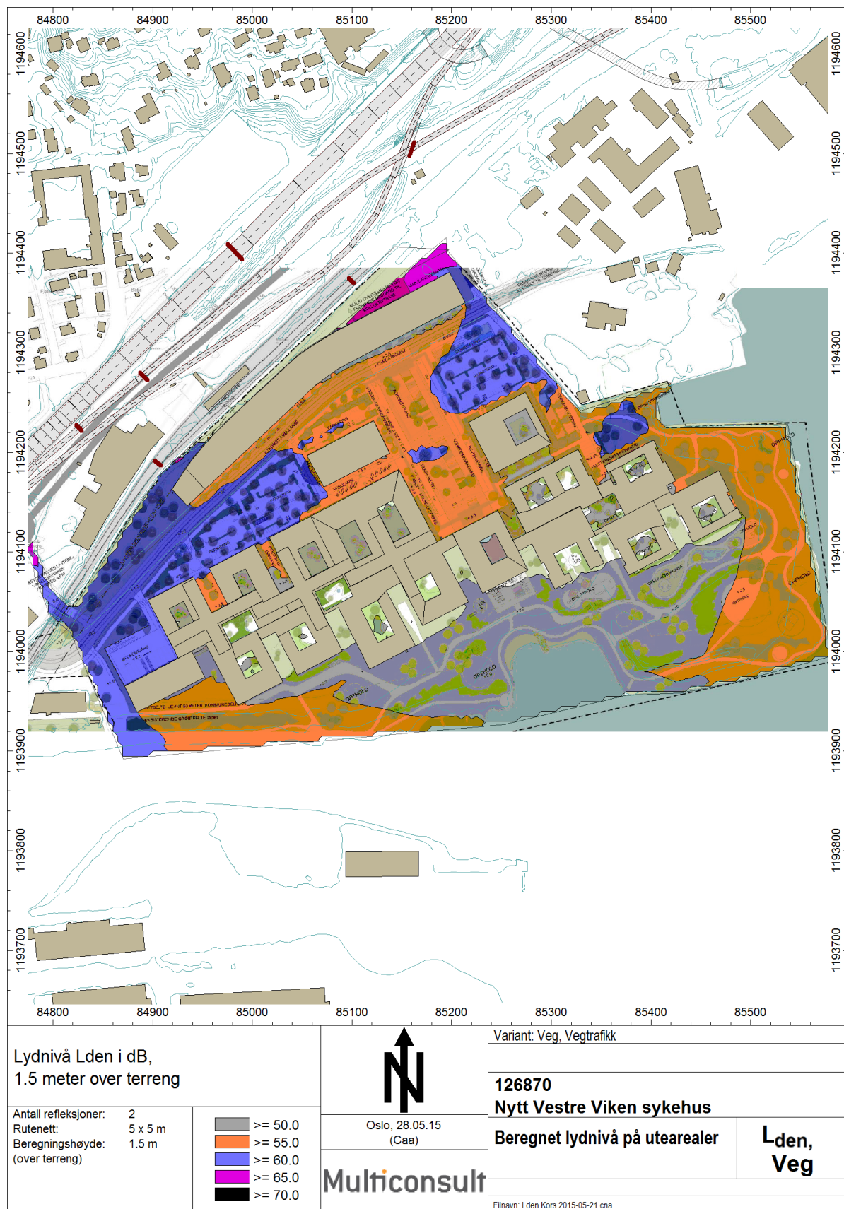
Figur 10: Lydnivå Lden [dB] fra vegtrafikk på utendørs oppholdsarealer. Beregningshøyde er 1,5 m over terreng.
