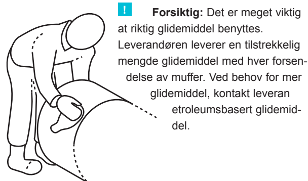
Figur 4-4 Rengjøring av spissende
