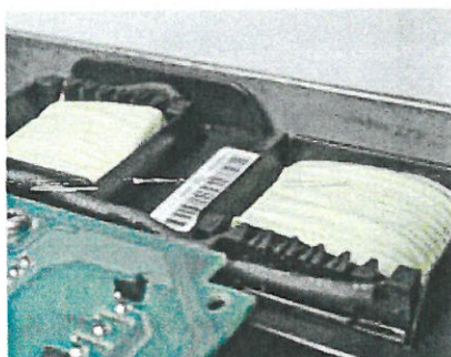
DC-spoler reduserer harmonisk støy og beskytter frekvensomformer. Også EMC-filtre er integrert (oppfyller EN 55011 A2, A1 eller B).
