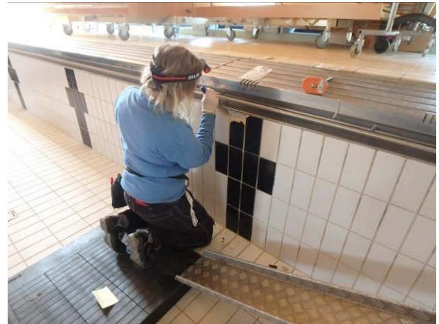
Bilde 7 viser prøvetaking av hvit keramisk flis og grå fugemasse mellom flisene som ble analysert for asbest. Det ble ikke påvist asbest i fugemassen eller keramisk flis. Dersom flis og fugemasse skal fjernes, skal det håndteres som forurensede masser og leveres til godkjent mottak.
