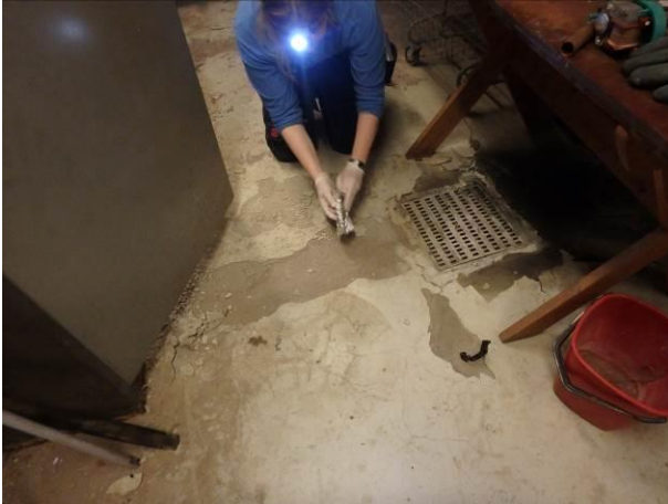
Bilde 28 viser prøvetaking av epoxy. Epoxyen er forurenset med arsen.
