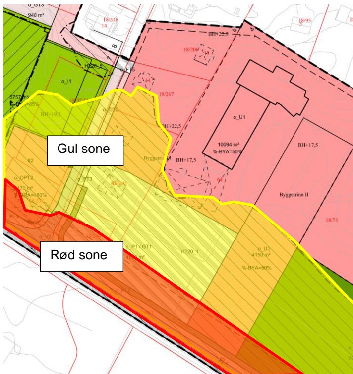
Figur 2: Utsnitt fra i reguleringsplanen som viser rød og gul støysone fra vegtrafikk ihht. T-1442 (4 m høyde). Støynivå på uteplass (1,5 m høyd) er lavere.
