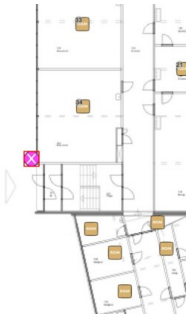
Bilde 4: Viser plassering av fasadeplatene som antas å inneholde asbest. Funnstedet er markert med X
