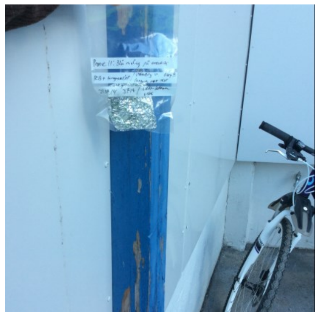
Bilde 42: Utvendig maling på fløy C er ikke påvist å inneholde tungmetaller over gjeldene grenseverdier
