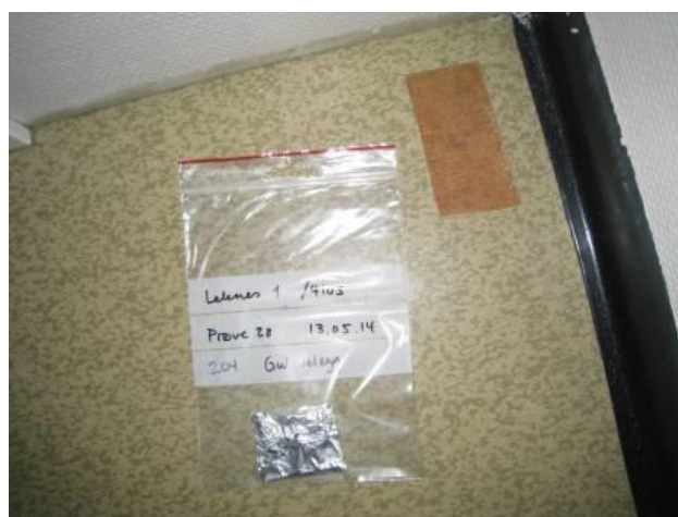
Bilde 26: Prøve 28 viser innhold av ftalater klassifisert som farlig avfall.
