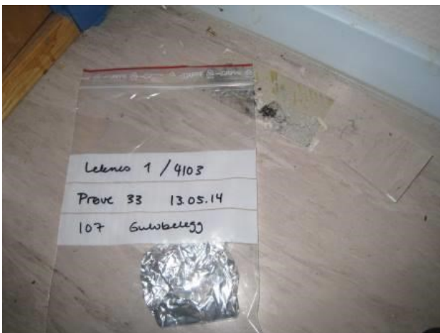
Bilde 31: Prøve 33 viser innhold av ftalater klassifisert som farlig avfall.
