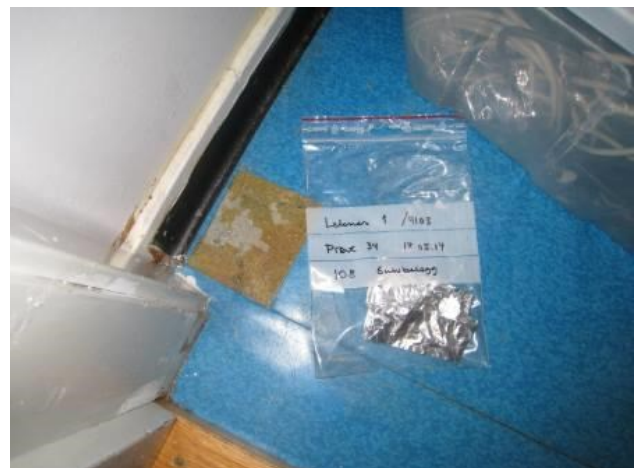
Bilde 32: Prøve 34 viser innhold av ftalater klassifisert som farlig avfall.
