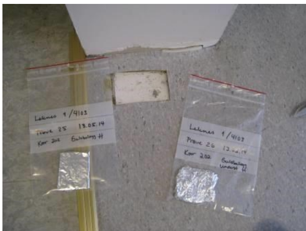
Bilde 23: Prøve 25 viser innhold av ftalater klassifisert som farlig avfall.
