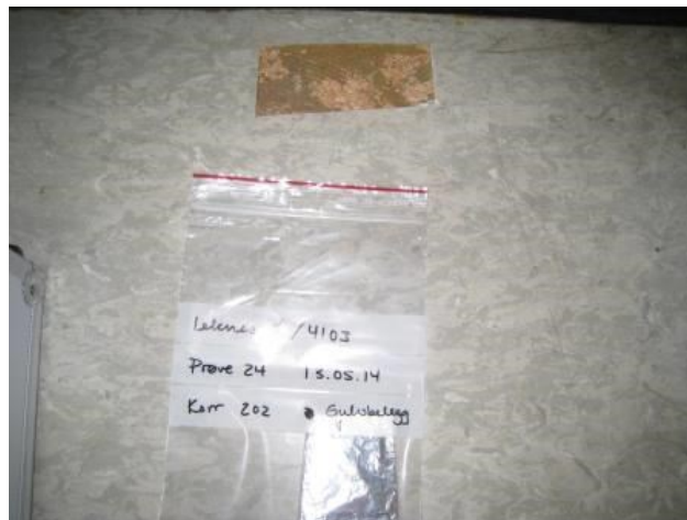
Bilde 22: Prøve 24 viser innhold av ftalater klassifisert som farlig avfall.
