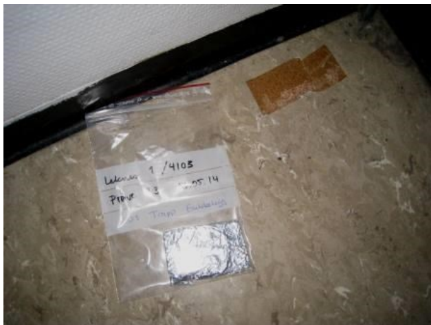
Bilde 21: Prøve 23 viser innhold av ftalater klassifisert som farlig avfall.
