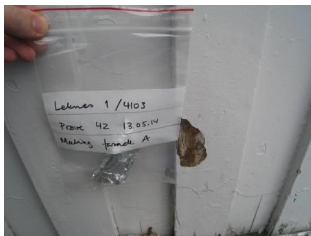
Bilde 15: Prøve 42 viser innhold av tungmetaller klassifisert som farlig avfall.
