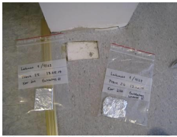
Bilde 24: Prøve 26 viser innhold av ftalater klassifisert som farlig avfall.
