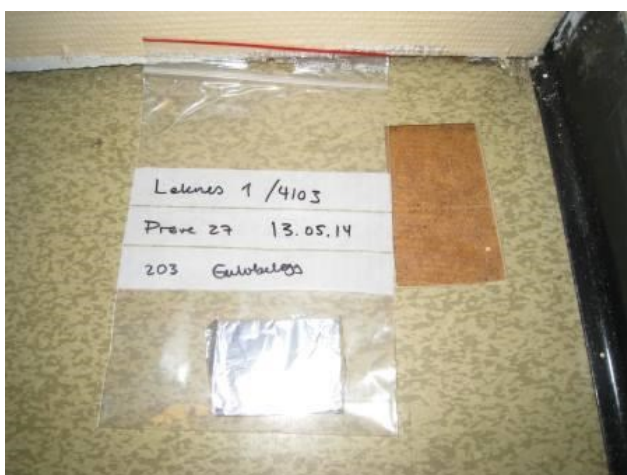
Bilde 25: Prøve 27 viser innhold av ftalater klassifisert som farlig avfall.
