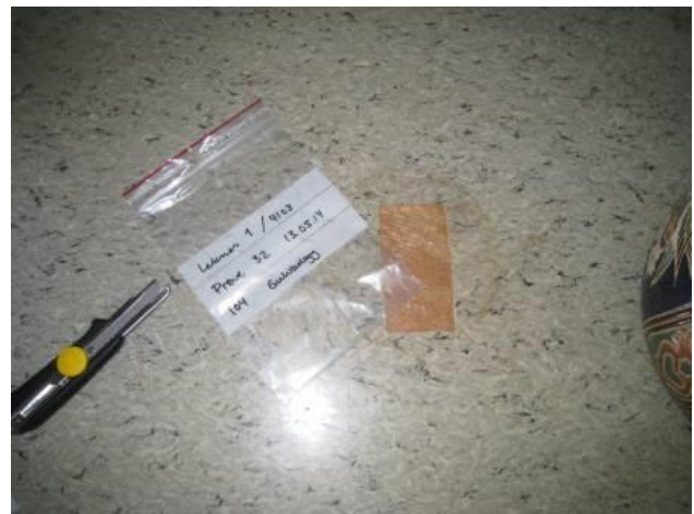
Bilde 30: Prøve 32 viser innhold av ftalater klassifisert som farlig avfall.
