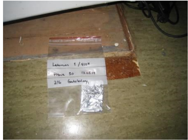
Bilde 28: Prøve 30 viser innhold av ftalater klassifisert som farlig avfall.
