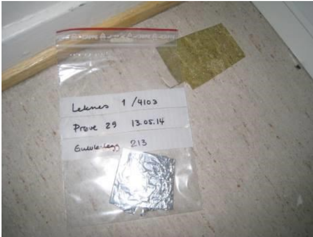
Bilde 27: Prøve 29 viser innhold av ftalater klassifisert som farlig avfall.
