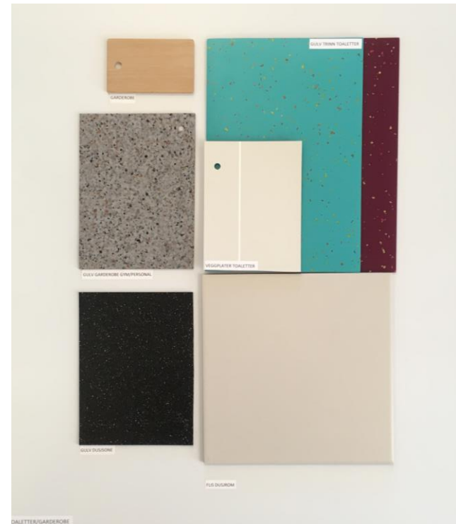
Toaletter og garderober. Trinntoaletter fargerikt guly, lysgrå veggplater. Personaltoaletter/garderobe mønstret gråttgolv med lysgrå veggplater. Dusjrom i svart golv med lys varm flis.
