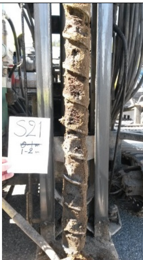
Foto 6. Typisk borekjerne fra området, denne er fra 1-2 m i S21. Øvre halvmetre viser fyllmasser, som ned mot 2 m går over i silt og så leire.
