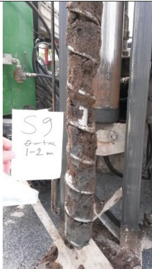
Foto 4. Borekjerne fra 1-2 m i prøvepunkt S9. I massene fra 1-1,5 m ble det påvist benzo(a)pyren tilsvarende tilstandsklasse 3.
