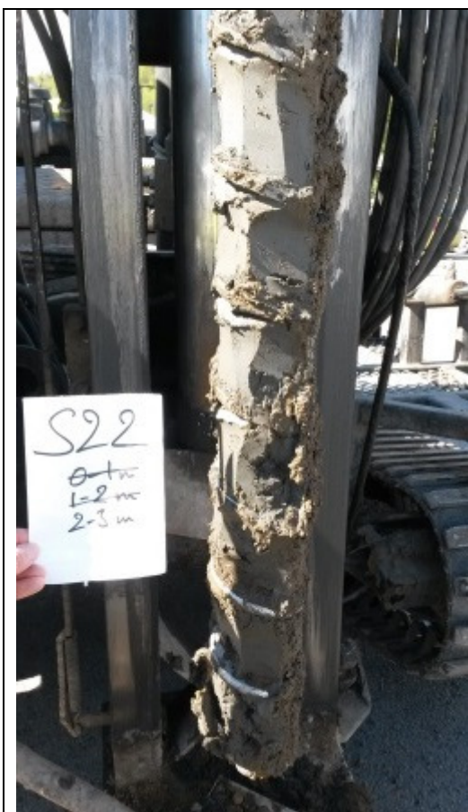
Foto 5. Det var kompakt, tett, leire under topplaget. Denne borekjernen er fra 2-3 m i punkt S22.
