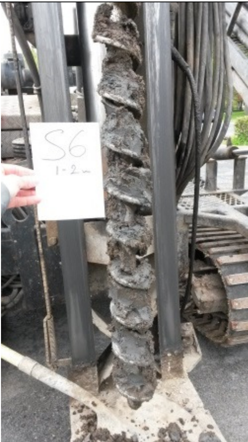
Foto 3. Borekjerne fra 1-2 m i prøvepunkt S6. På 1,1 m ble det påvist PCB i tilstandsklasse 4. Fra 1,1 m og nedover er det marin leire.
