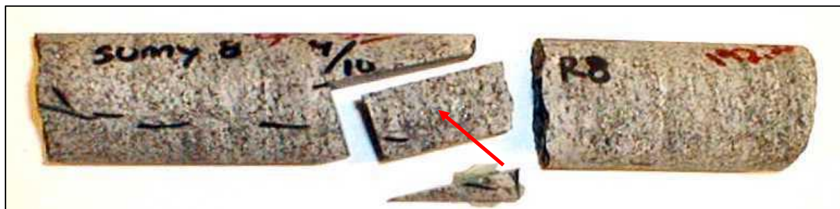
En seksjon av en borkjerne med ferdig kuttet SJ-stykke (markert med rød pil) orientert i forhold til kjerneaksen og foliasjonen til bergarten.
