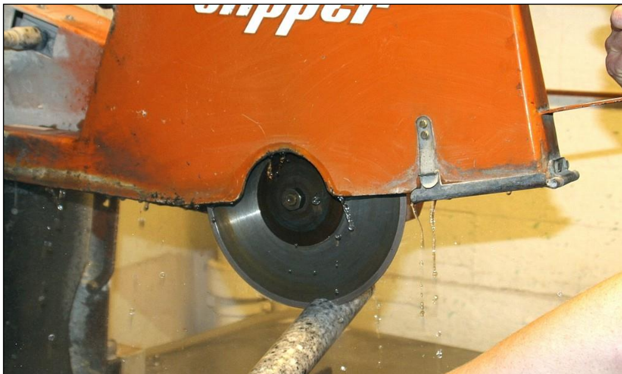
Kutting av et stykke fra en borkjerne for bestemmelse av Sievers' J-verdi.
