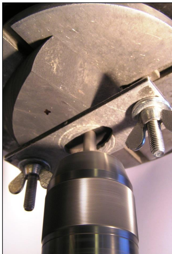
Nærbilde av boring i Sievers' J-stykke.
