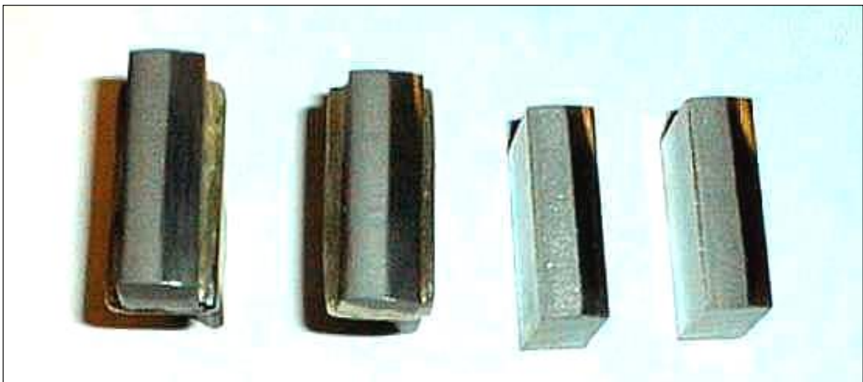
Slitasjestykker etter testing. Hardmetallstykker til venstre og kutterstålstykker til høyre.
