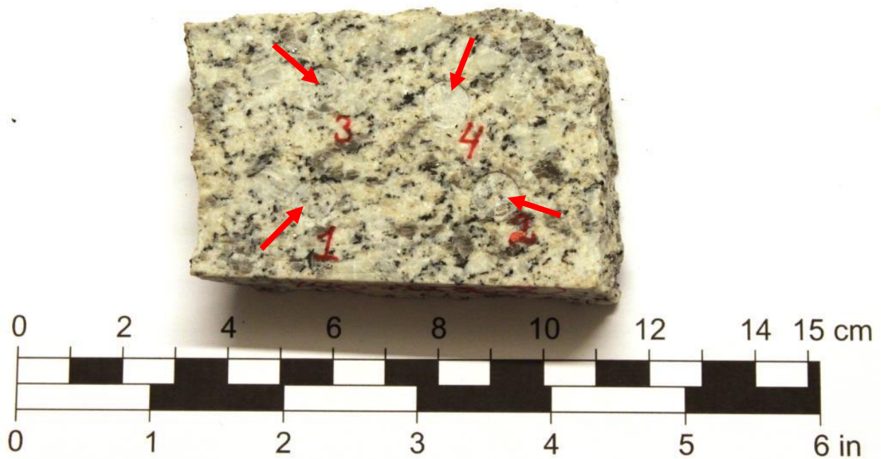
Foto av Sievers' J-stykke benyttet til testing. Blå piler indikerer posisjonen til borehullene.
