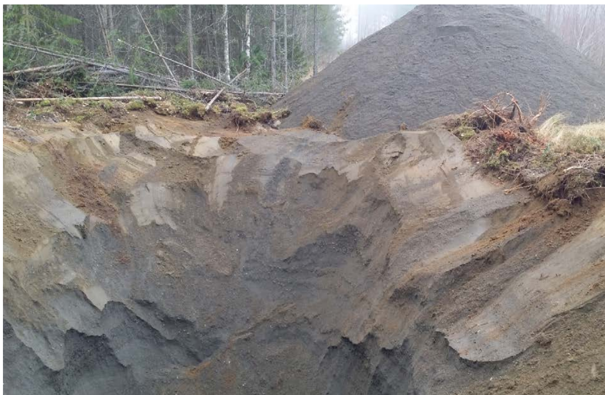
Bilde 2 viser prøvegropp G1 med ensgradert løst lagret sand
