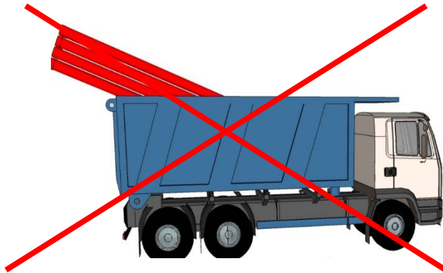
Figur 11 - RT9200 - Muffene må ikke berøre plan eller karm
