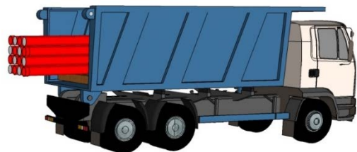
Figur 12 - RT9201 - Under transport skal rør hvile på strørbord
