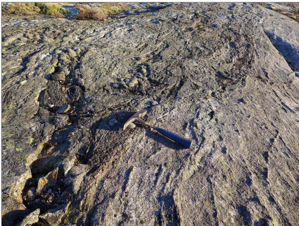
Bilde 4 Bergmassen på høydedraget mellom dam og overløpsterskel. Granitt/granittisk gneis med slirer av glimmergneis.
