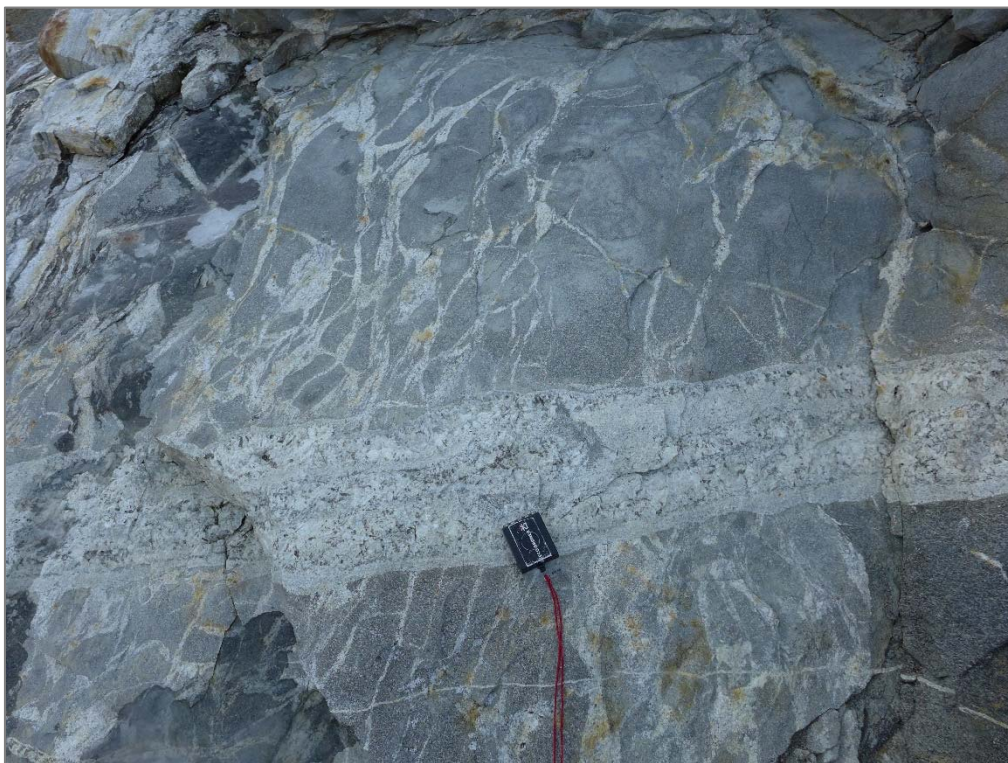
Bilde 6 Bergmassen nedstrøms avsats fra overløp, i elveleiet. Granittisk gneis med ganger og slirer av granitt og porfyrgranitt. Det er også observert bånd av glimmergneis i bergmassen i dette området.
