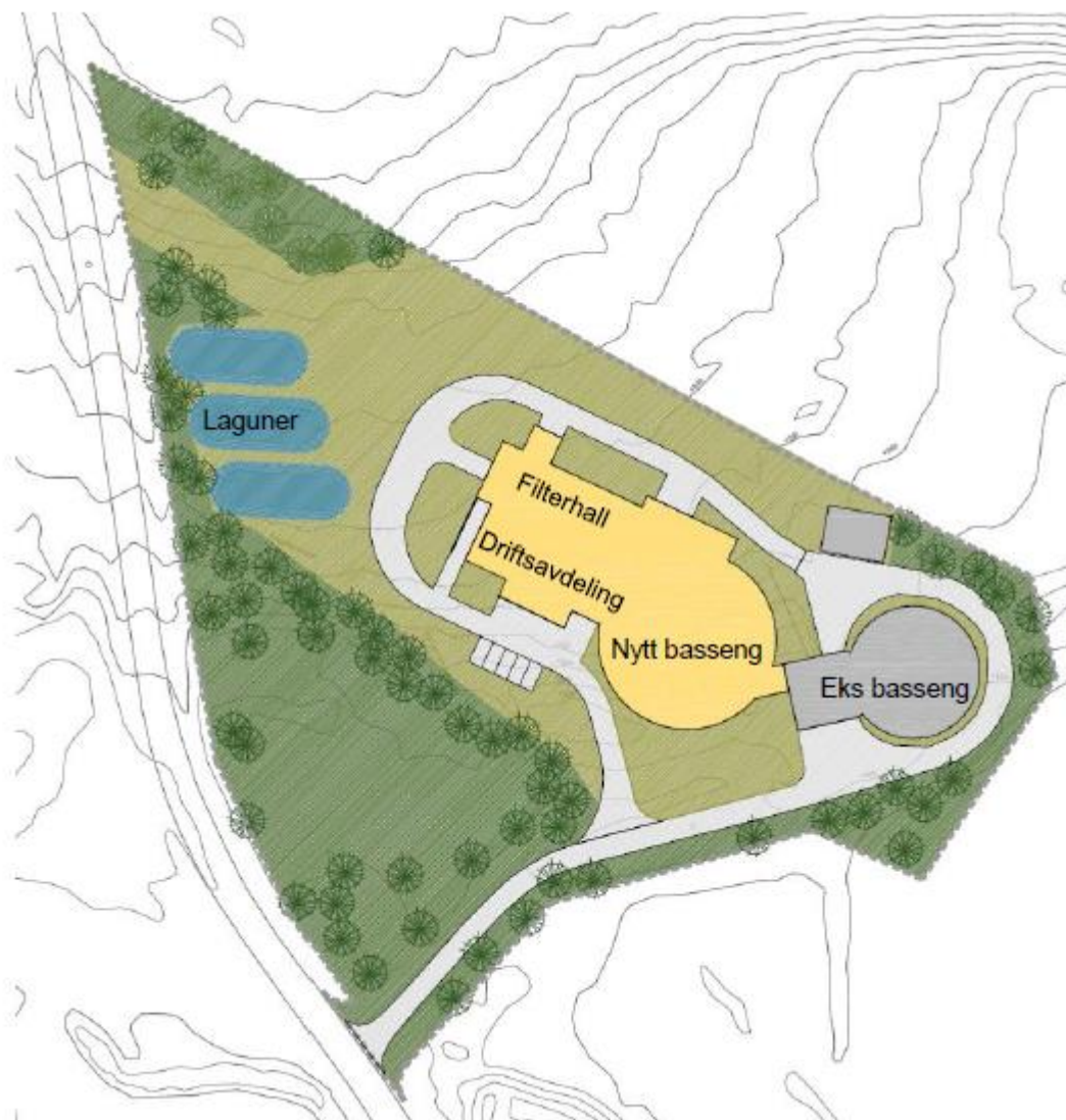
Figur 2 Utforming av vannbehandlingsanlegget fra Forprosjektet (Asplan Viak 2015).
