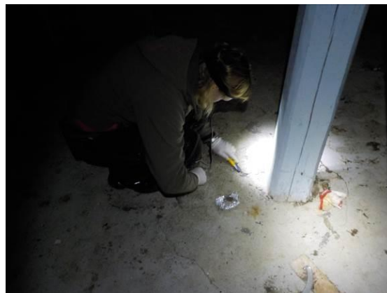
Bilde 20 viser prøvetaking av gråmaling på betonggulv i mellomgang i kjeller. Malingen er forurenset med bly og sink.
