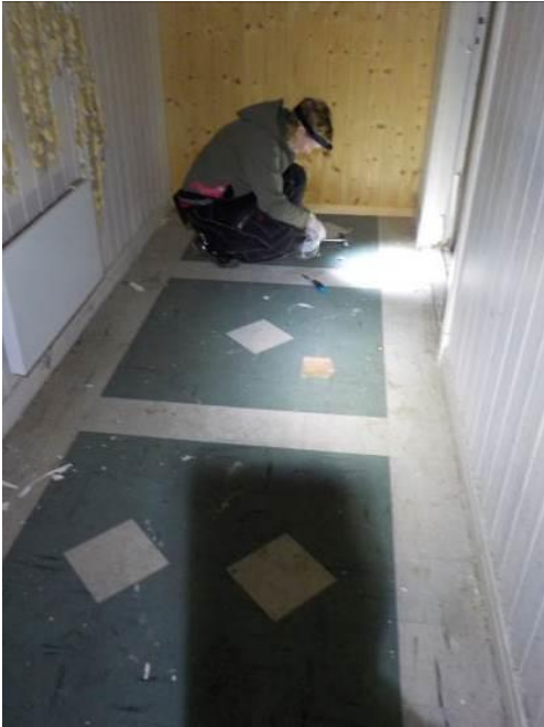
Bilde 5 viser prøvetaking av grønne og hvite gulvfliser. Flisene inneholder ikke asbest.
