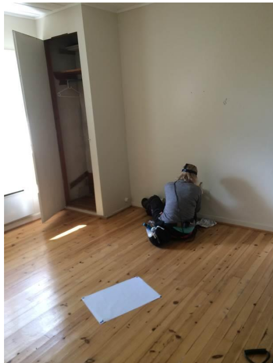
Bilde 20 viser prøvetaking av beige maling i rom 9B2 i 2. etasje i 9B. Malingen er forurenset med PCB, bly og sink.
