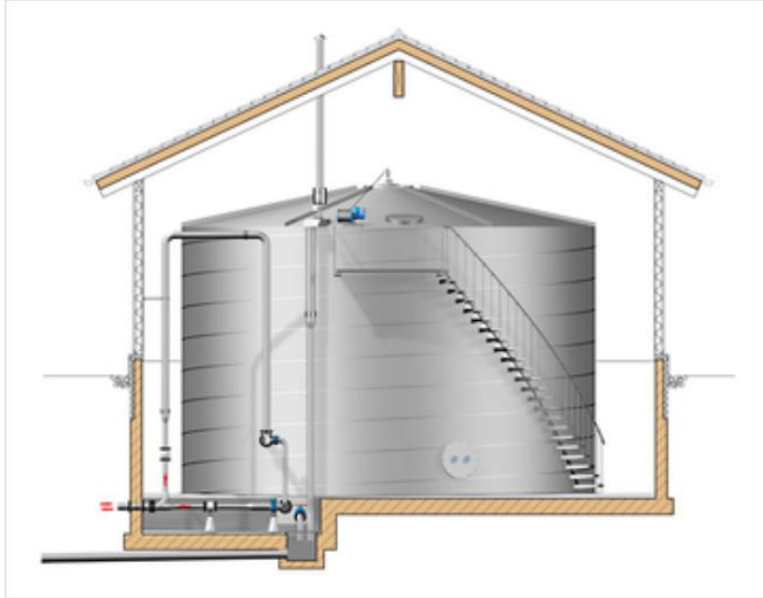
Figur 1: Prinsipløsning for stålbaseng med bygg rundt. Figur er hentet fra Norsk vann Rapport 181/2011.
