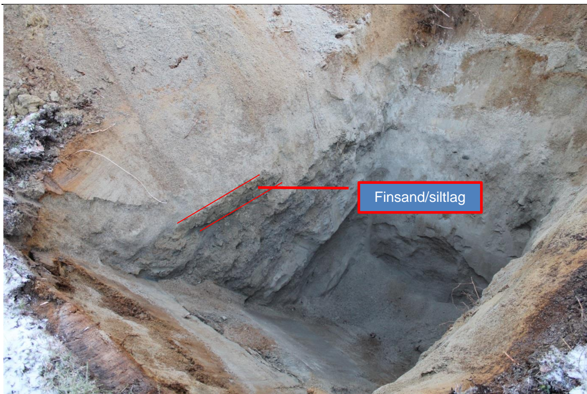
Bilde 2 fra sjakt 2: Middelskornig sand (1,2 m) over lagdelt sand og grus. Tynt lag med finsand/silt i overgangen.
