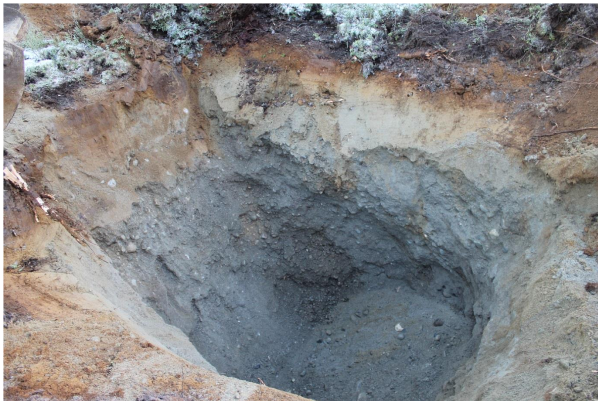
Bilde 3 fra sjakt 3: Middelskornig sand (0,8 m) over grov sand og grus.
