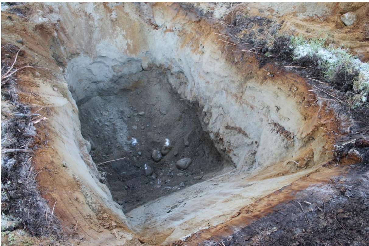
Bilde 1 fra sjakt 1: Middelskornig sand (1,5 m) over steinholdig grov sand og grus.
