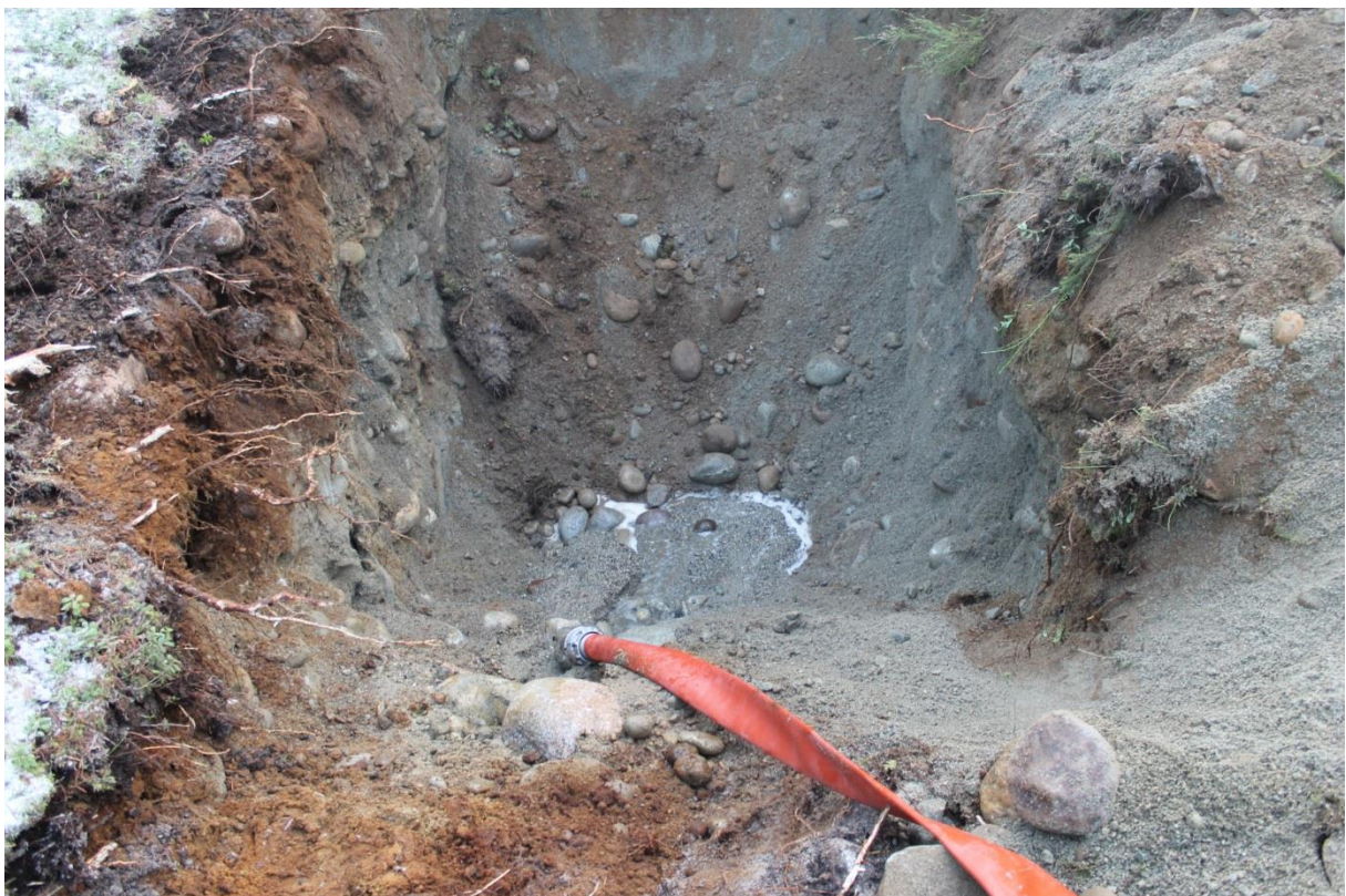
Bilde 5 fra sjakt 5: Rødlig sand (0,5 m) over steinholdig grov sand og grus.
