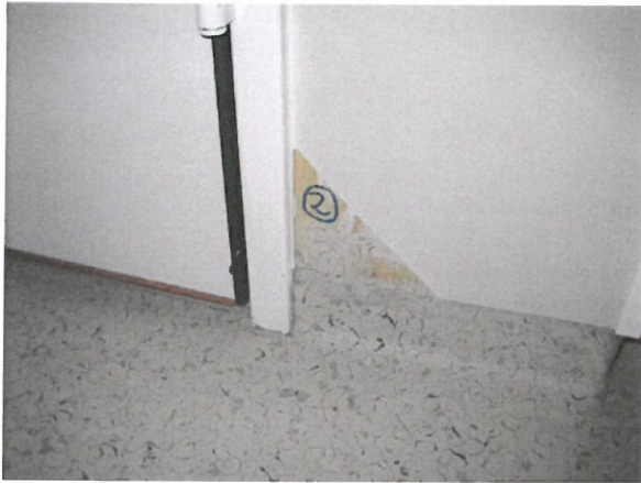
Foto 1: Prøve 2 av vinyltapet på vegg inneholder mindre mengder tungmetaller, og ftalater over grense for farlig avfall.
